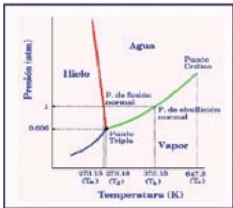
Figura 2. Diagrama de fases del agua.
